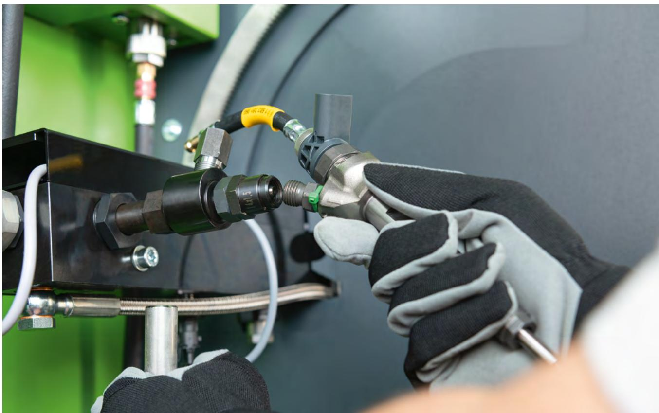
Las últimas normas sobre emisiones de gases de escape y las futuras directivas en los motores diésel modernos aumentan la importancia de comprobar los inyectores common-rail. Por tanto, cuanto más precisa sea la medición, con mayor exactitud se podrá adaptar el inyector.
